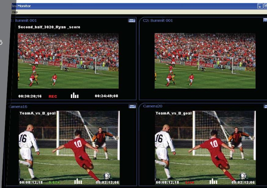
VGAマルチビューアーは、ChannelFlex使用時には、リアルタイムに最大8チャンネルの表示機能を提供します。
