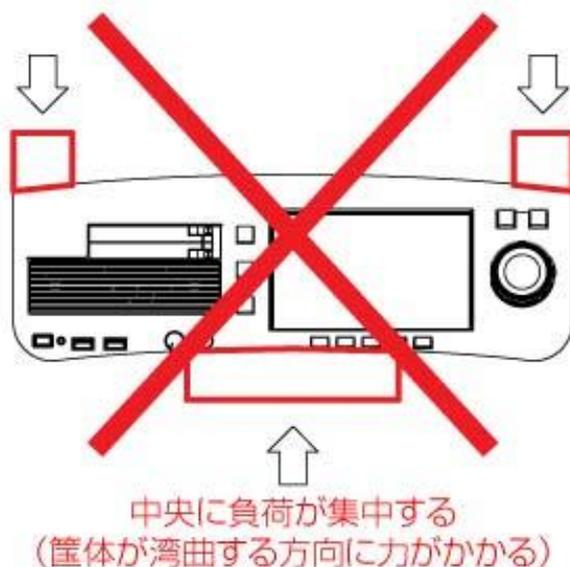
3. 筐体重量の応力バランス、および筐体からの放熱状態を確保するため、T2の動作はキャリングケースから取り出した状態で行うこと
