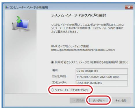
9 バックアップされたイメージが格納されているドライブを選び、[次へ] をクリックする
